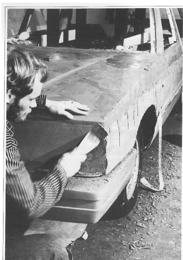
Bild 5. Volvomodell formas i lera och trä. FORM 1983/8 (Copyright CC-BY-NC-ND)
